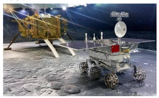
玉兔号月球车设计质量137千克,能源为太阳能,能够耐受月球表面真空、强辐射、零下180摄氏度到零上150摄氏度极限温度等极端环境。月球车具备20度爬坡、20厘米越障能力,并配备有全景相机、红外成像光谱仪、测月雷达、粒子激发X射线谱仪等科学探测仪器。
